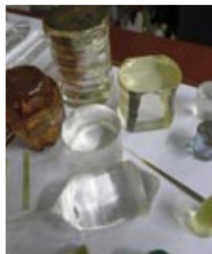
Kryształy różnych metali wyprodukowane metodą Czocharalskiego w Instytucie Technologii Materiałów Elektronicznych w Warszawie (zdjęcie autora)
