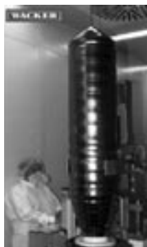
Monokryształ krzemu o średnicy 300 mm, długości 2 m i wadze 265 kg (Wacker Chemie AG, Silicon AG)
