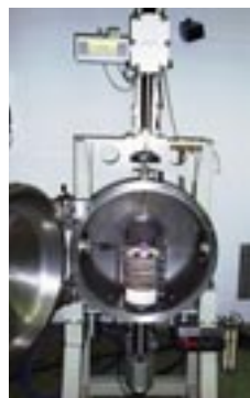
Współczesne urządzenie do produkcji kryształów metodą Czocharalskiego znajdujące się w Instytucie Technologii Materiałów Elektronicznych w Warszawie (ze zbiorów ITME)
